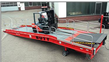
zwölf Tonnen, ihre Bedienung geschieht mit einer Mehrknopfsteuerung, sodass die Rampe in kürzester Zeit mit dem Gabelstapler befahren werden kann.
