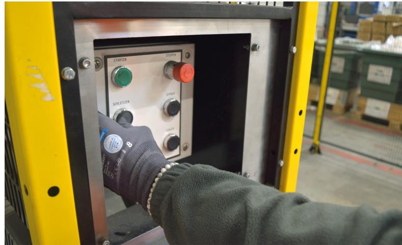
Über eine Konsole kann das Lagerpersonal die verschiedenen Elemente des Palettenwenders bedienen
