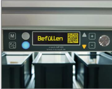
Kombination mit einer höheren Pixeldichte sowie den variablen Displayinhalten. Damit lassen sich neben Zahlen und Texten auch Grafiken oder QR-Codes abbilden. Mit seinem OLED-Punktmatrixdisplay kann das MP100 damit bis zu 80 Zeichen visualisieren. Darüber hinaus ermöglicht
